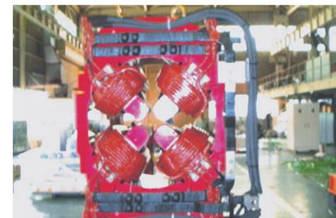
【加速器用極電磁石コイル】
